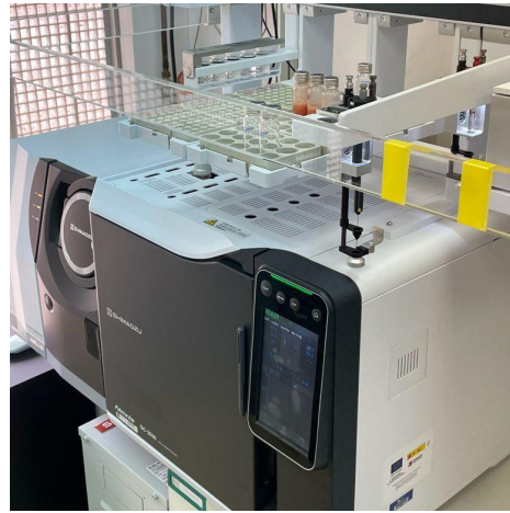
Proceso de análisis de espacio de cabeza y compuestos volátiles. Fuente: Ramiro Alonso
