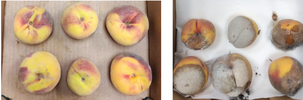
Melocotones conservados a temperatura ambiente con (izquierda) y sin (derecha) filtros KEEPCOOL a día 7 de ensayo. Fuente: Ramiro Alonso Salinas.
