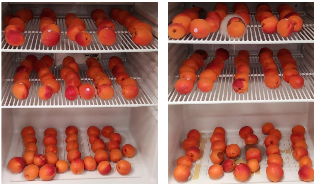
Albaricoques conservados con (izquierda) y sin (derecha) filtros KEEPCOOL a día 10 de ensayo. Fuente: Ramiro Alonso Salinas.
